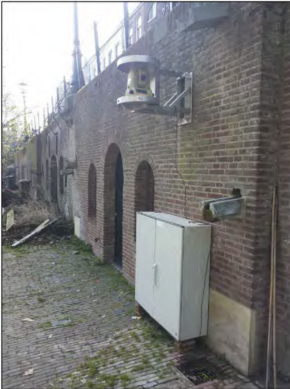
Figuur 5: Voorbeeldfoto Robotic Totalstation Leica TCA 1800
